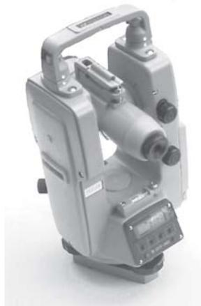
Figura 1.3.4 Teodolito Electrónico TOPCON DT-30
