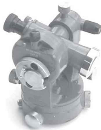
Figura 1.3.2 Teodolito Opticomecánico Kern DKM-1
