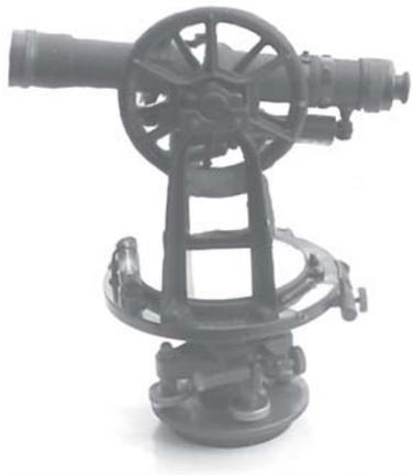
Figura 1.3.1 Teodolito Opticomecánico K&E
